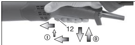
**Conexión:** encienda la máquina tal y como se describe más arriba. Ahora vuelva a deslizar hacia delante el interruptor (12) y suéltelo en la posición delantera para que el interruptor (12) quede bloqueado (funcionamiento continuo).
