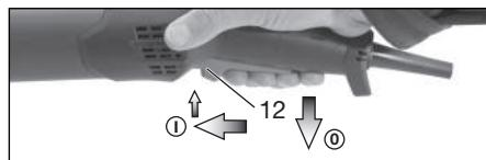
**Conexión:** deslice el interruptor (12) hacia delante y después presione hacia arriba el interruptor (12).
