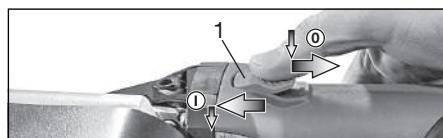
**Conectar/Funcionamiento constante:** desplace el relé neumático (1) hacia adelante. Para un funcionamiento continuado, moverlo hacia abajo, hasta que encaje.
