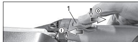
**Marche/fonctionnement en continu :** Pousser l'interrupteur coulissant (1). Pour un fonctionnement en continu, le basculer vers l'arrière jusqu'au cran.
